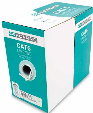
Câble réseau CAT 6 d'intérieur gainé PVC, bobine de 305 mètres composée de 4 paires équilibrées de 100 Ohm avec des conducteurs flexibles en cuivre rouge AWG 24. Les caractéristiques répondent aux exigences de la **Cat. 6 Classe E** jusqu'à 250 Mhz selon les normes ANSI/TIA 568.2-D et ISO/IEC 11801. Convient aux applications Gigabit Ethernet (IEEE 802.3ab).
